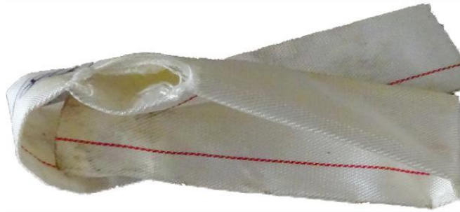
图9 消防水带最小爆破压力不合格
